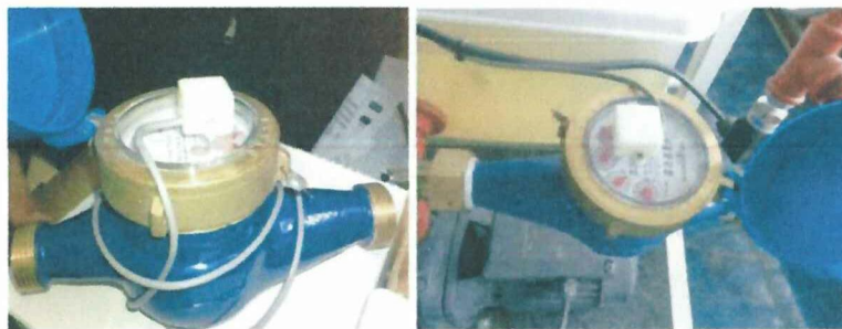
FIGURA 3.5. EMISOR DE IMPULSOS TIPO “REEDSWITCH”
