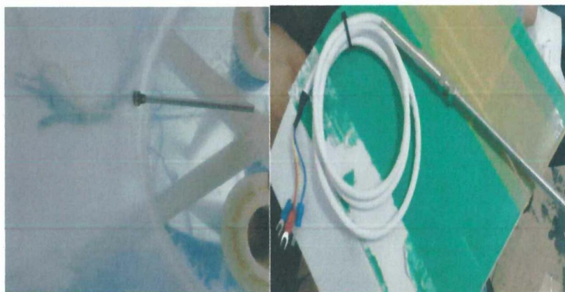
FIGURA 3.1. SENSOR DE TEMPERATURA (PT-100)
