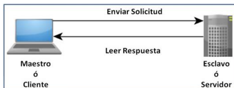
Figura 7. Esquema protocolo Modbus [17]
