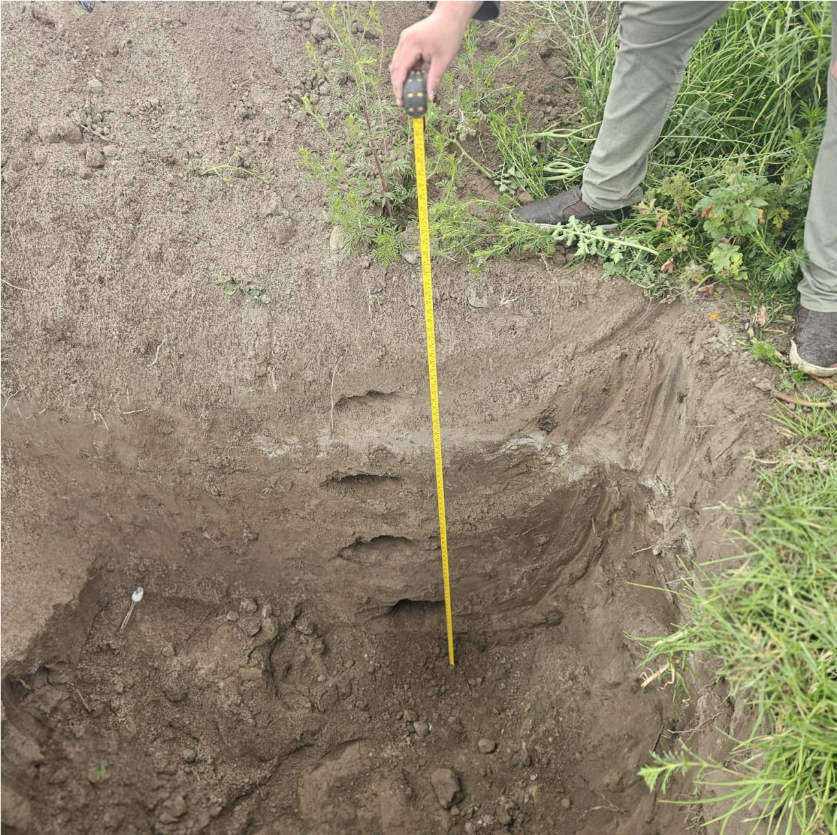
Anexo 37. Medición de la profundidad de la calicata N°11 en el sector La Victoria
