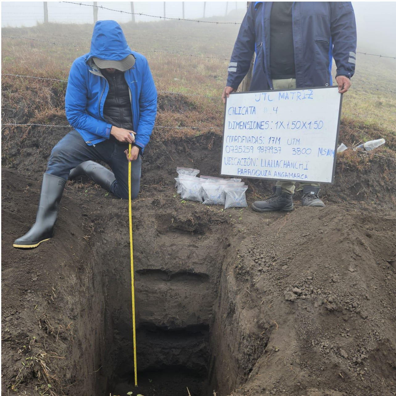
Anexo 14. Medición de los horizontes de la calicata N°4 en el sector Llallachanchi
