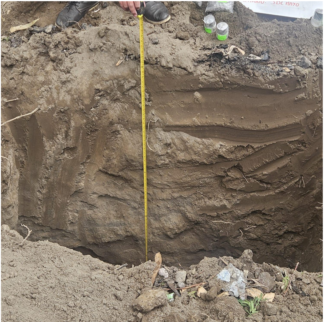
Anexo 18. Medición de la profundidad en la calicata N°5 en el sector 3 de Mayo - Pujilí
