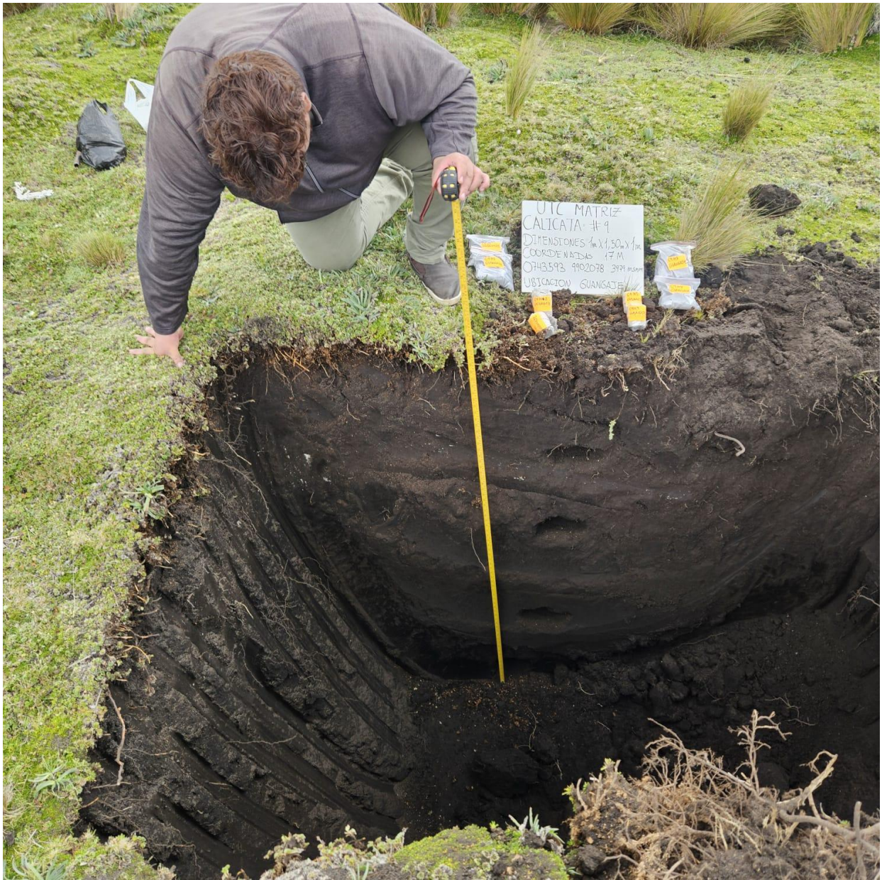
Anexo 30. Medición profundidad calicata N°9 en el sector Guanaje
