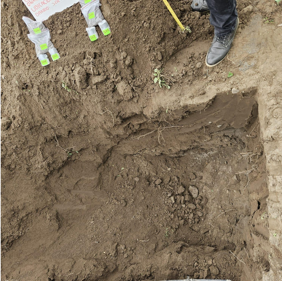
Anexo 21. Excavación de la calicata N°6 en el sector 3 de Mayo - Pujilí
