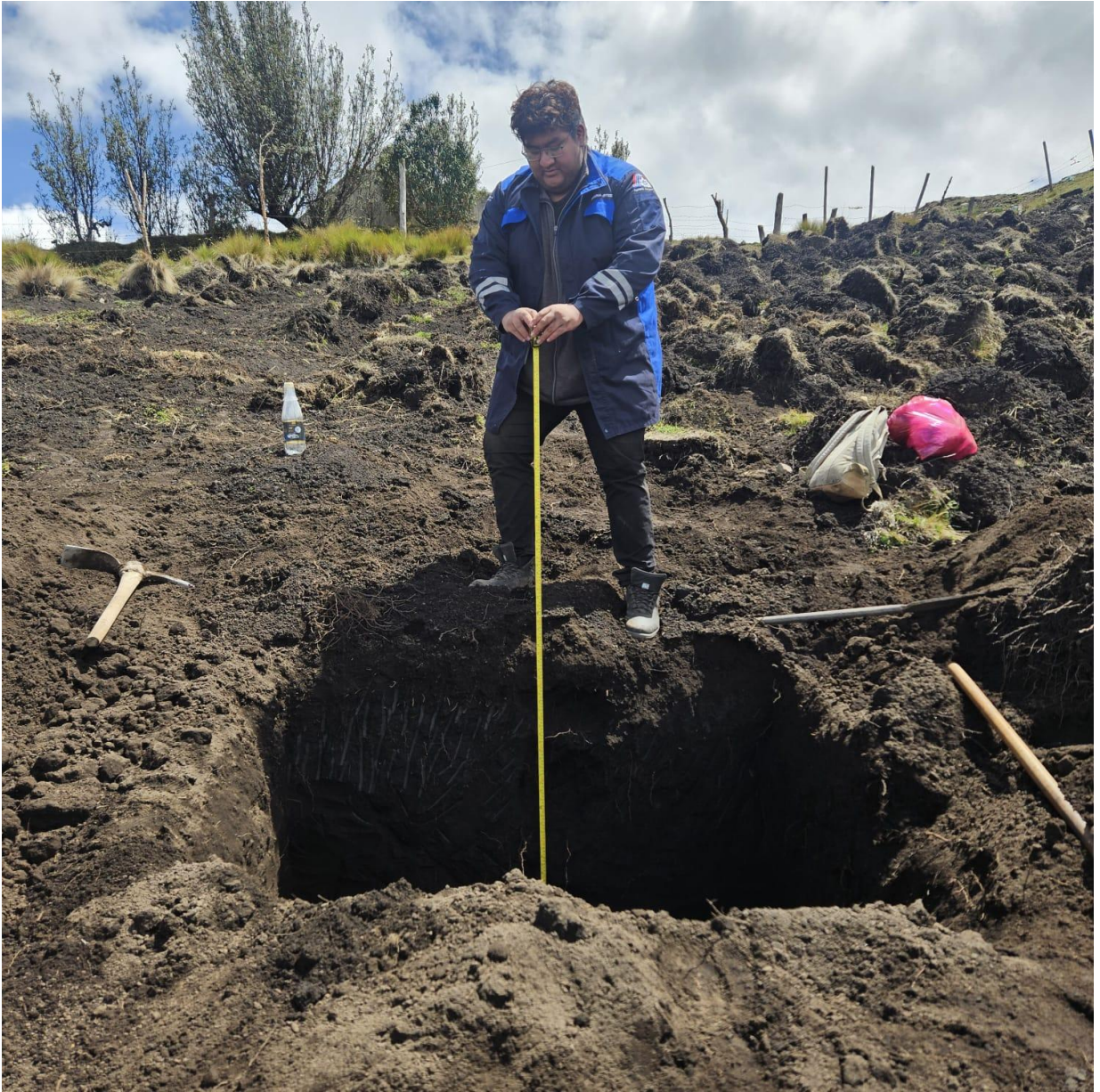
Anexo 6. Medición de la calicata N°2 en la zona de Apagua
