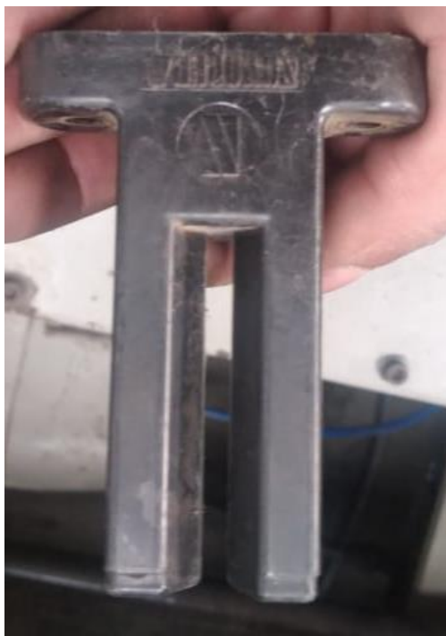
Figura II. 12. Sensor de ranura implementado en la selladora.
