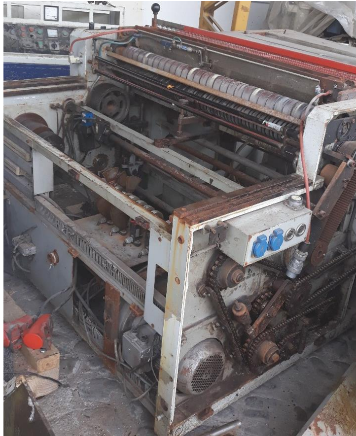
Figura I. 1. Estado inicial de la máquina selladora de fundas plásticas.
