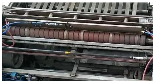
Figura 3. 8. Sistema de arrastre de película plástica.
