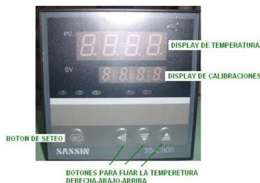
Figura 5. 3. Controlador de temperatura.
