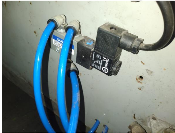
Figura 5. 8. Electroválvula para activar el pistón del funcionamiento duplicado.
