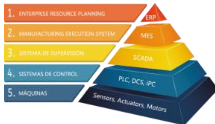
Figura 3. 11. Pirámide jerárquica de automatización.
