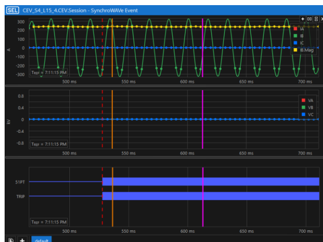
Figura 20. Registro oscilográfico de la actuación de la función de sobrecorriente del relé SEL-351.
