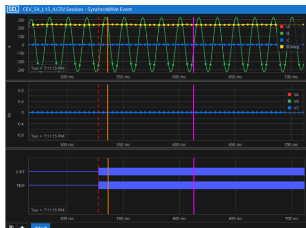
Figura 21. Registro oscilográfico de la actuación de la función de sobrecorriente del relé SEL-351.
