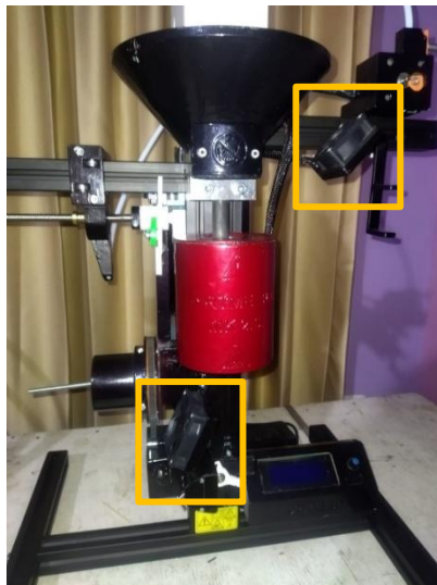
Figura 5. 40 Sistema de refrigeración
