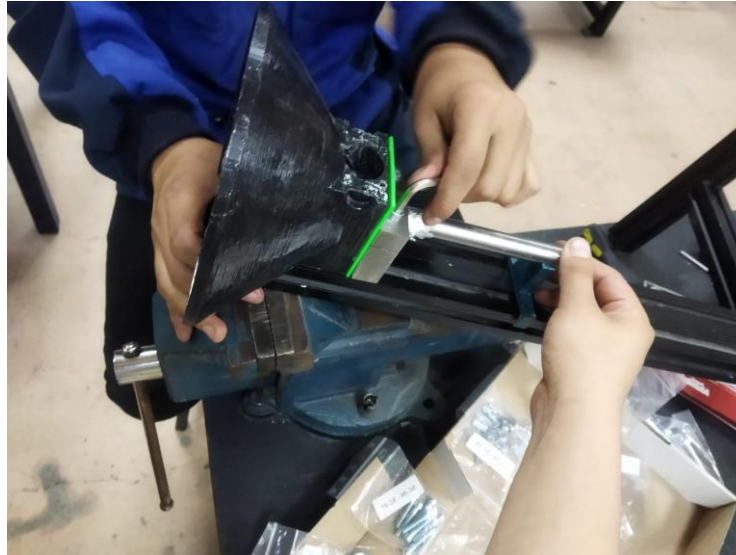
Figura 5. 35 Instalación de la tolva con cilindro
