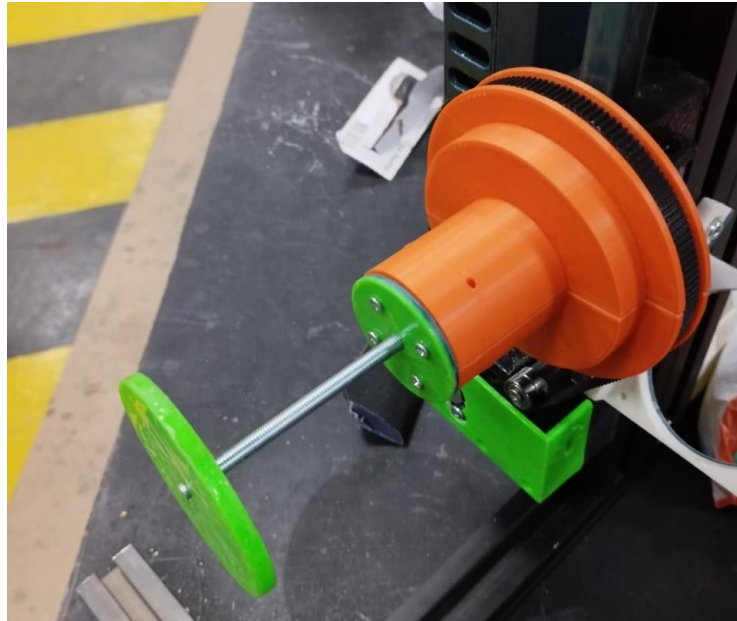
Figura 5. 43 Banda transportadora y piezas para carrete
