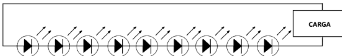
Figura 2. Conexión en serie.
