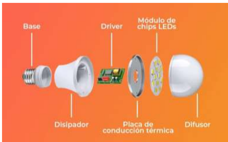
Ilustración 15. Componentes de una lámpara led.
