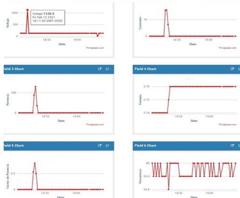
Figura 5.17. Visualización de parámetros eléctricos en ThingSpeak (Línea 2).
