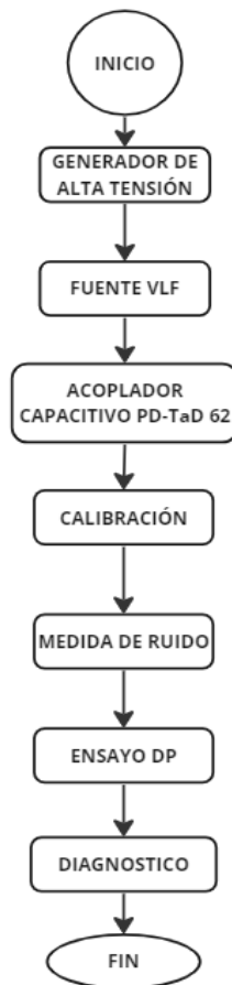
Figura 10. Diagrama simplificado de conexión del equipo.
