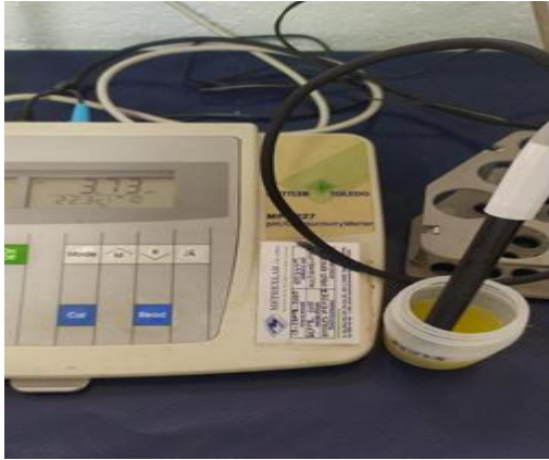
Fotografía 11: Introducción del electrodo.
