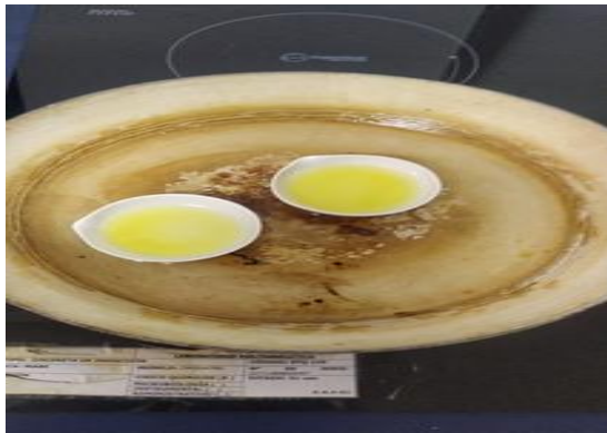
Fotografía 7: Muestra en la Mufla a 500°C.
