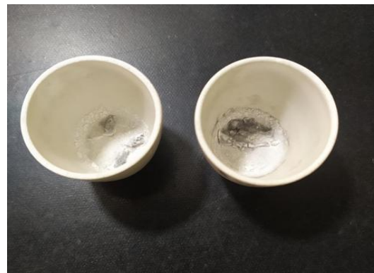
Fotografía 8: Resultado de la prueba de la ceniza.
