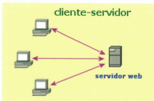
Figura 1.1 Esquema de una arquitectura Cliente/Servidor.
