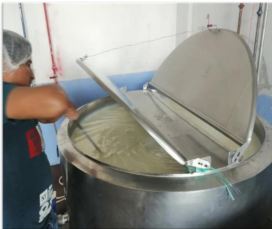
Figura B.4. Proceso de batido y saborizado del yogur.
