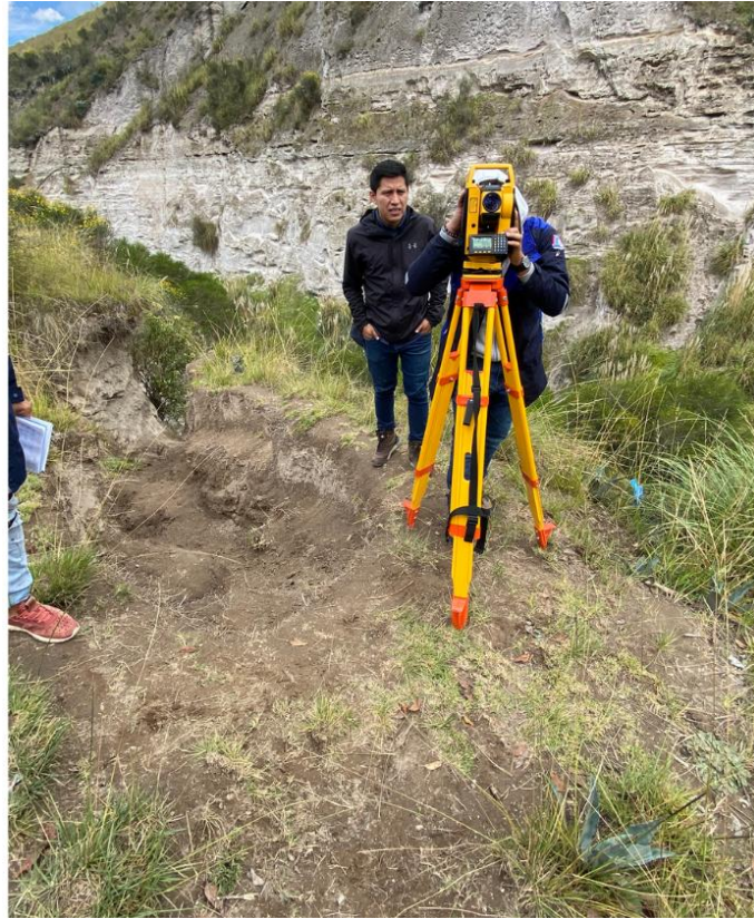
Figura A 3. Toma de datos topográficos
