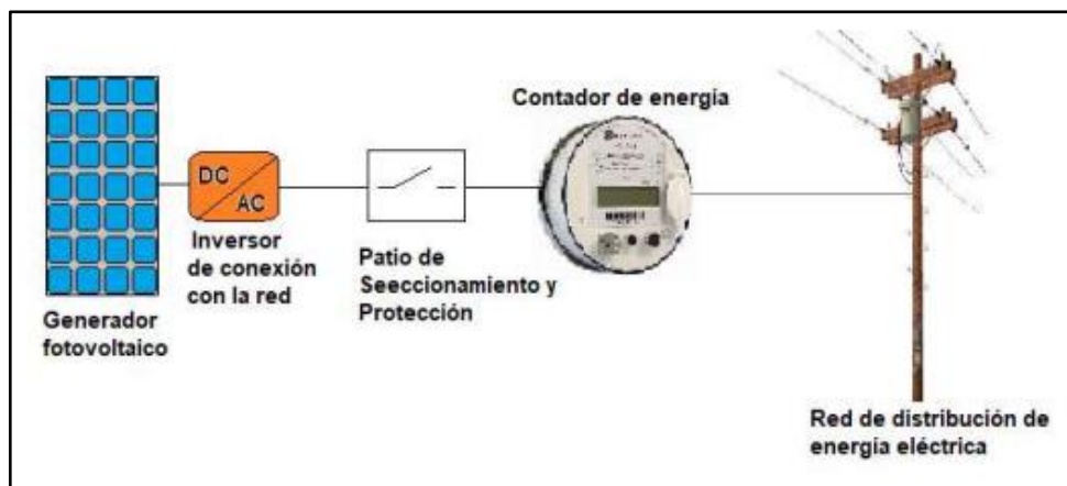
Figura 14. Sistema fotovoltaico de tipo On Grid [24].
