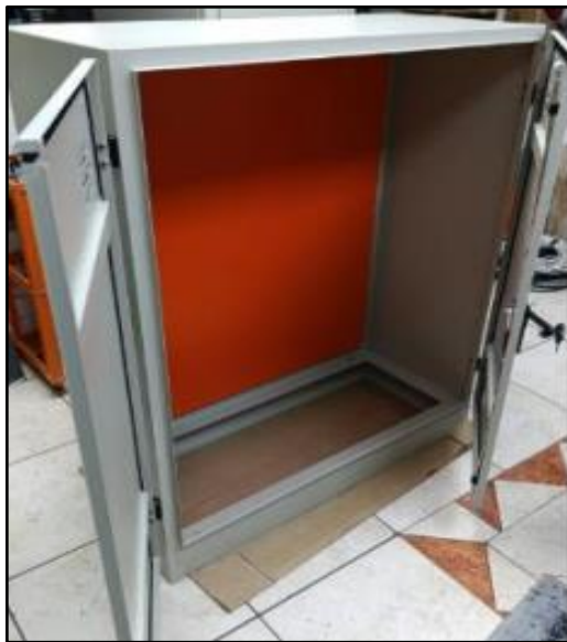
Figura 71. Construcción del tablero de transferencia para el sistema fotovoltaico.
