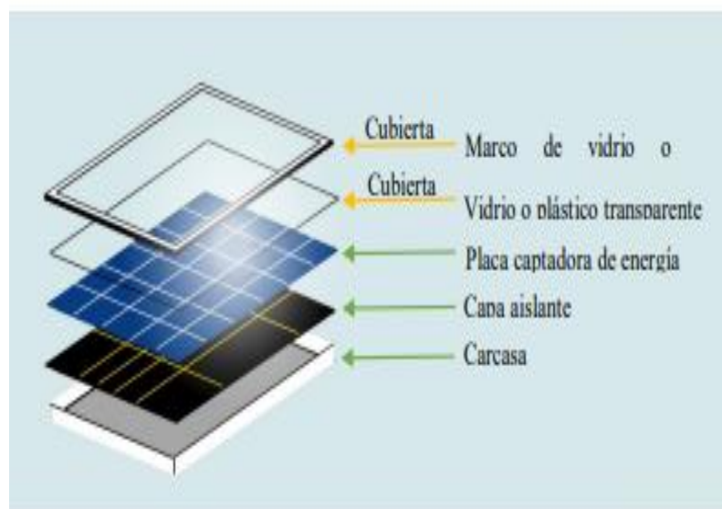
Figura 3. Elementos de un panel solar
