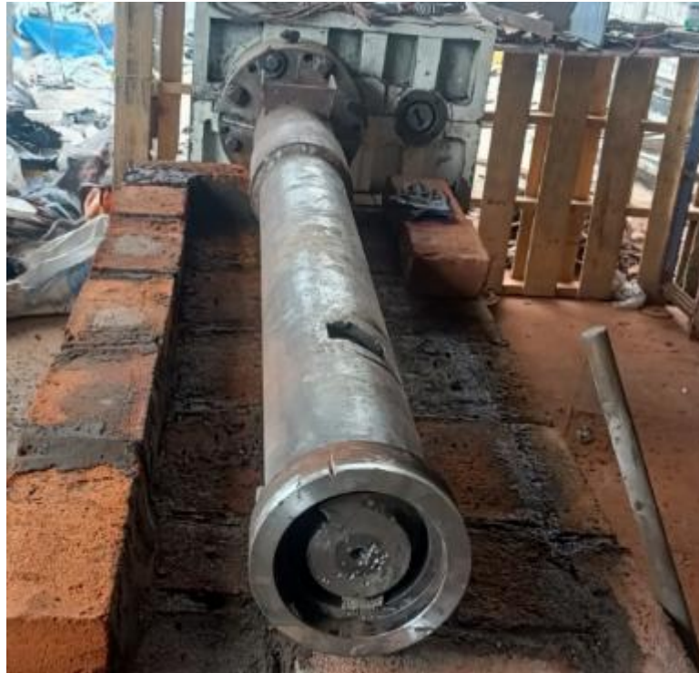
Figura 5.32 Correcta alineación del husillo y la camisa
