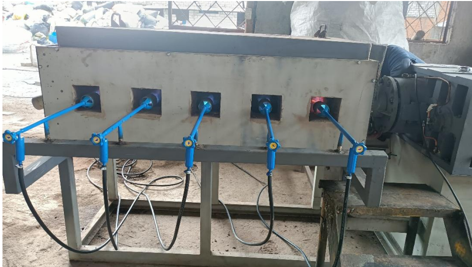
Figura 5.30 Sistema de calentamiento por sopletes en la extrusora
