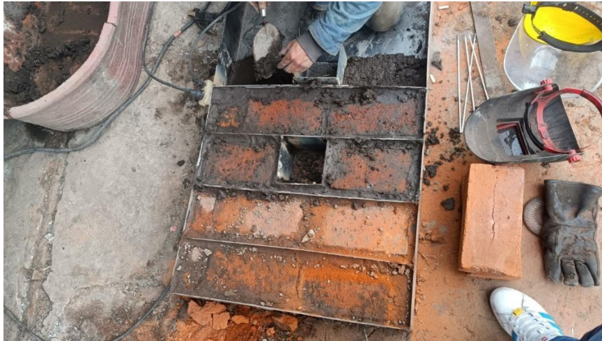
Figura 4.28 Fabricación de la tapa del recubrimiento térmico con material refractario
