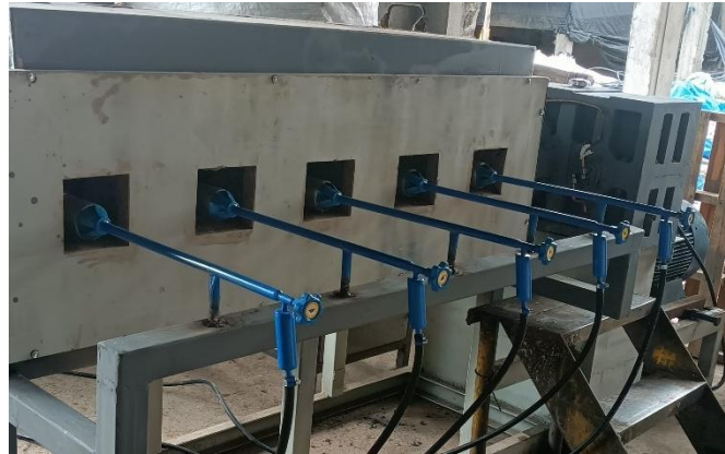
Figura 3.6 Calefacción por GLP
