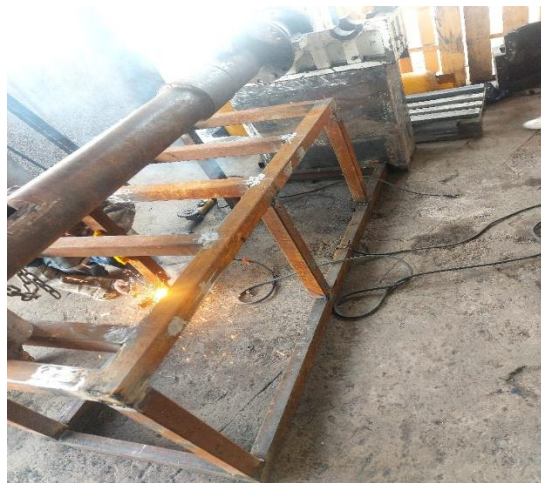
Figura 5.23 Estructura base completa
