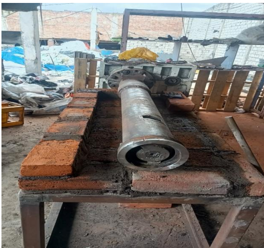
Figura 5.27 Construcción del recubrimiento térmico con ladrillos refractarios
