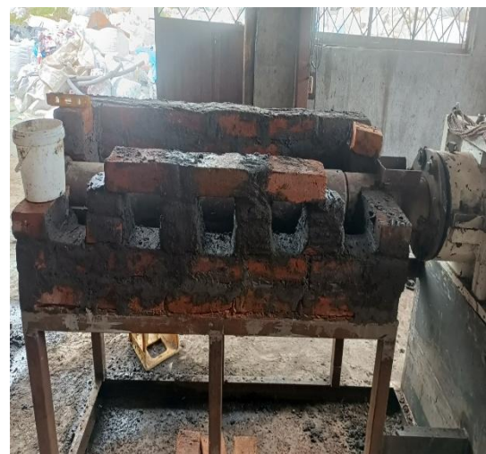
Figura 5.27 Construcción del recubrimiento térmico con ladrillos refractarios
