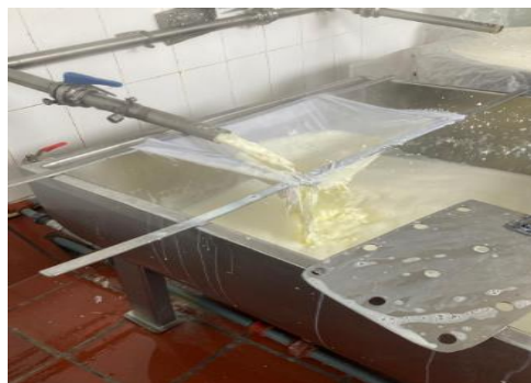
Figura 5.8. Enfriamiento de la leche pasteurizada.
