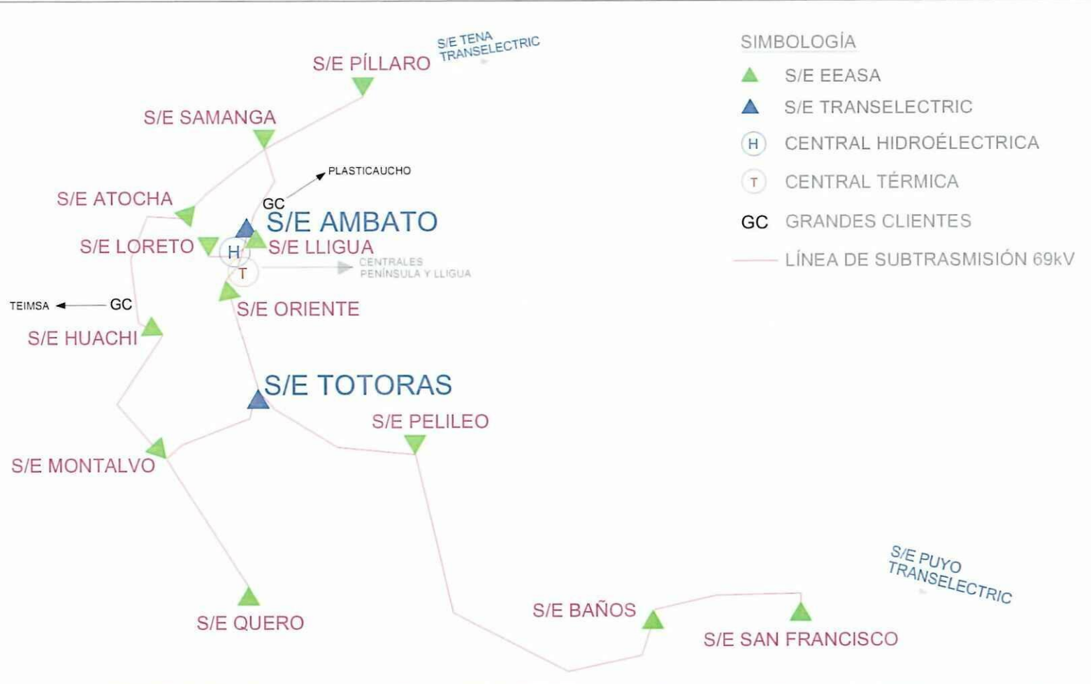
FIGURA No. 18: DISPOSICIÓN GEOGRÁFICA DE LOS COMPONENTES DEL SISTEMA ELÉCTRICO DE LA EEASA
