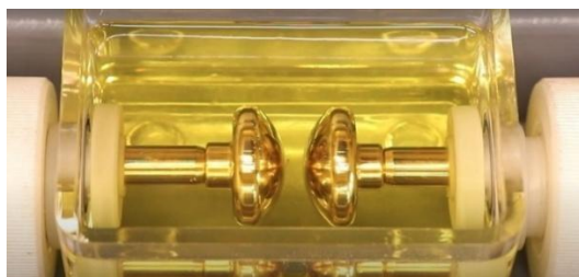
Figura 3.7 Ensayo de rigidez dieléctrica
