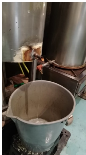
Figura 20. Recolecta cuerpo del segundo destilado.
