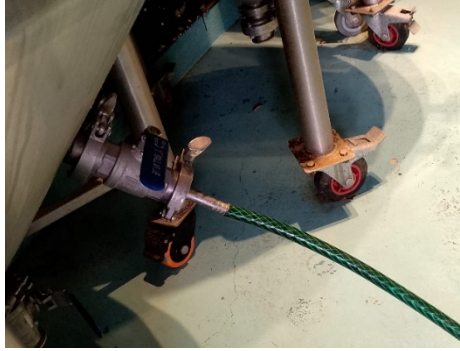
Figura 9. Conexión de la manguera de la bomba al fermentador.
