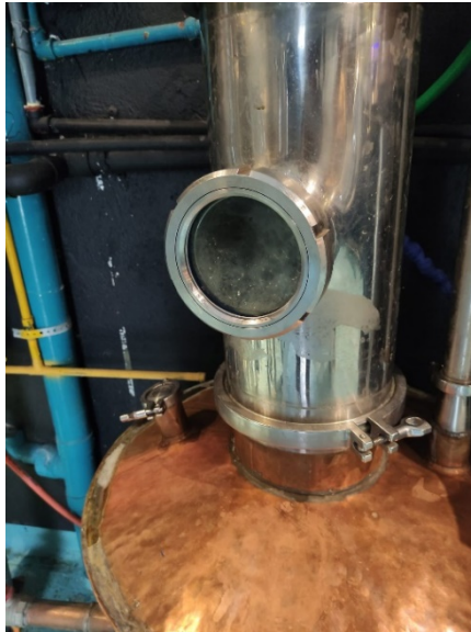
Figura 13. Torre de destilación sellada.
