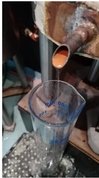
Figura 19. Recolecta la cabeza y cola del segundo destilado.
