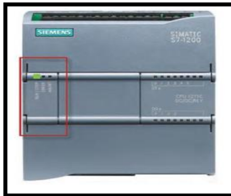
Figura 4.1. PLC SIEMENS S7-1200 [31].
