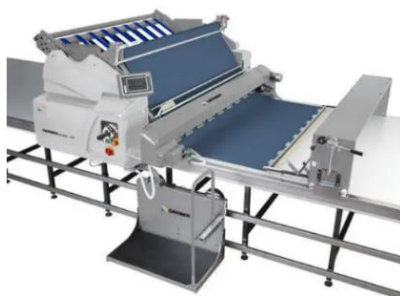
Figura 3.22. Carro tendedor automático [20].
