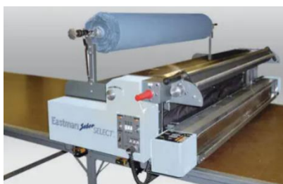
Figura 3.21. Máquina tendedora semiautomática [19].
