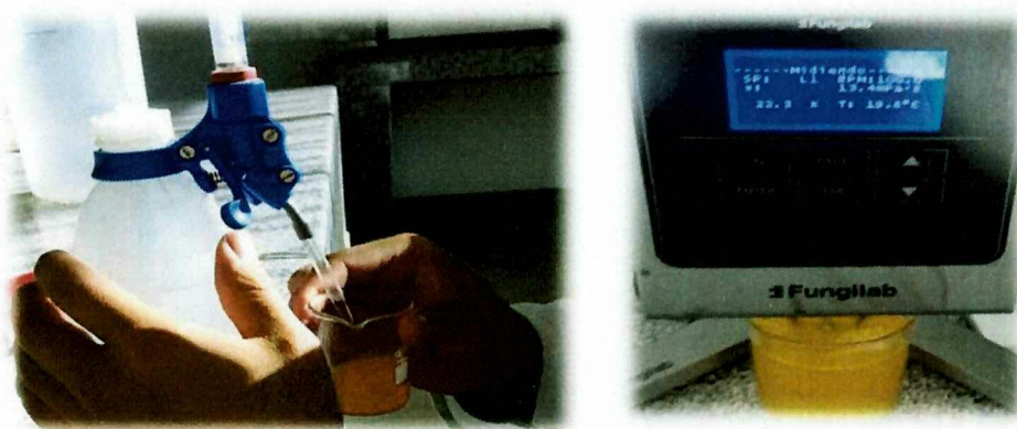
Fotografía 8: Medición de la acidez y viscosidad de la solución mucilaginosa
