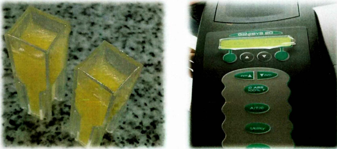
Fotografía 19: Medición de espectrofotometría al mejor tratamiento
