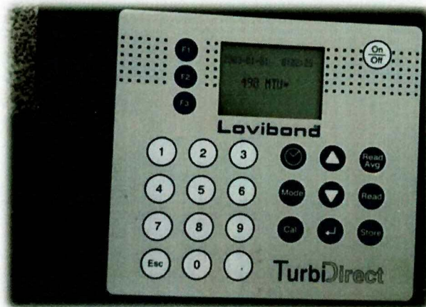
Fotografía 17: Medición de la turbidez de los diferentes tratamientos
