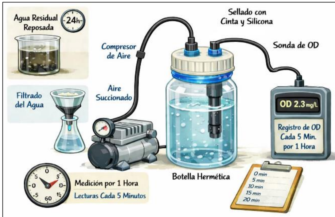
Figura 2. Sistema al vacío para el OD.
