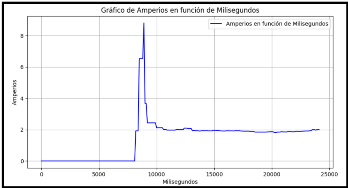
Figura 5.13. Comportamiento de la corriente durante el arranque estrella a 40Hz con carga hidráulica
