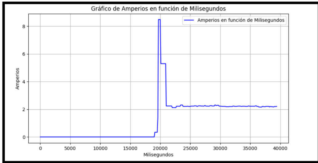
Figura 5.14. Comportamiento de la corriente durante el arranque estrella a 50Hz con carga hidráulica
