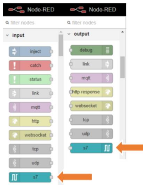
Figura 4.21. Nodo S7 instalado
