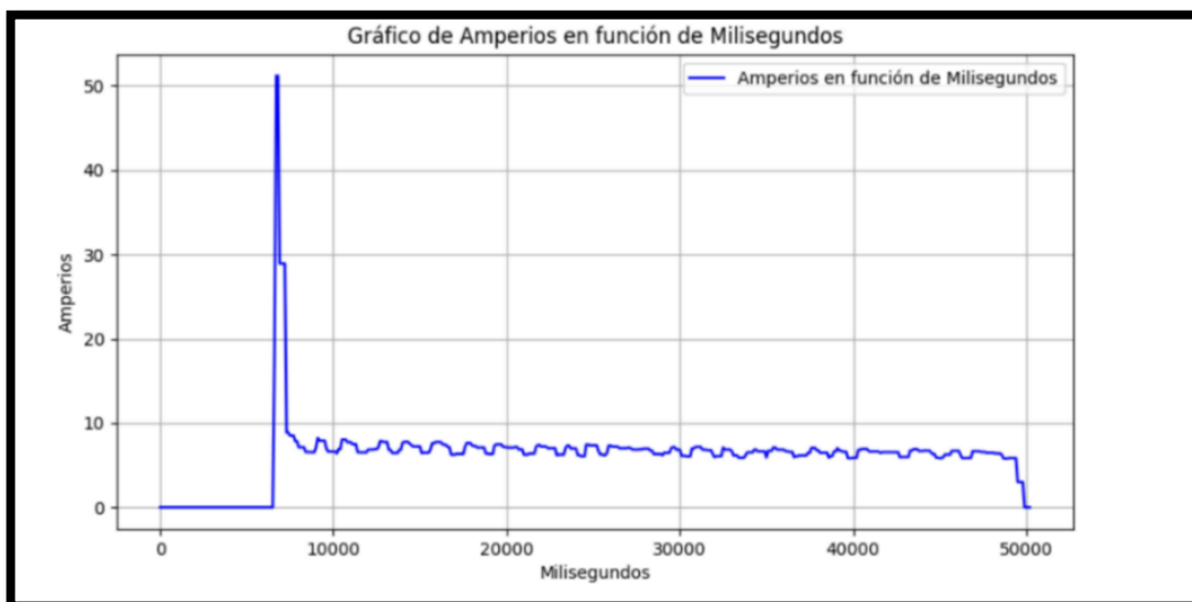
Figura 5.7. Arranque de comportamiento de corriente en arranque estrella con carga hidráulica.
