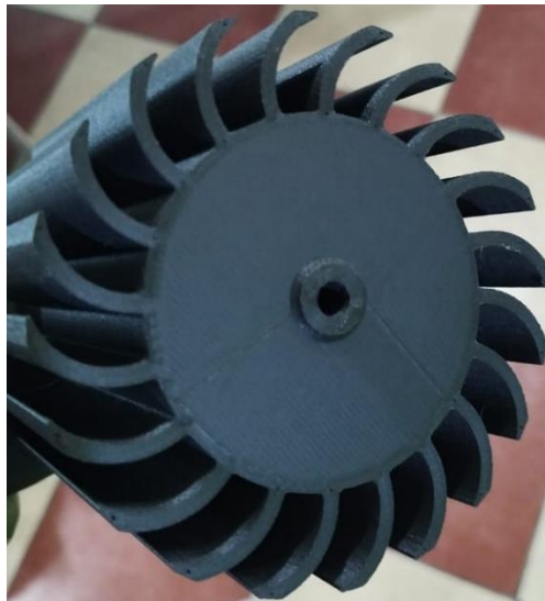
Ilustración 4 Rodete y álabes del prototipo real
