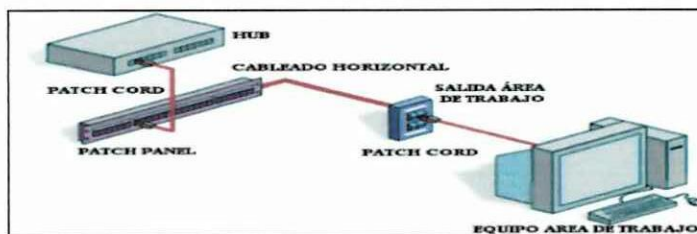
Gráfico N° 19 Componentes del cableado estructurado.
