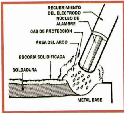
FIGURA 1. 11 Soldadura por arco eléctrico
