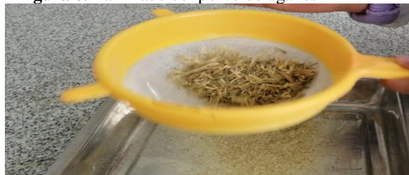
Figura 8. Tamizado del polvo de agaves
