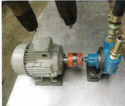
Figura 3.16. Sistema de acople de la Motor-Bomba.
