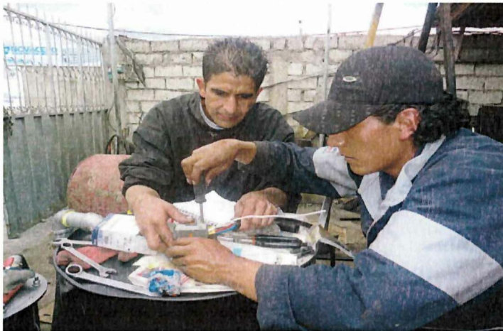
CONEXIÓN DEL CONTACTOR ELÉCTRICO.
