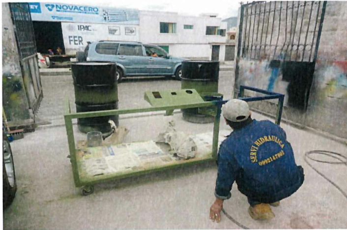
ESTRUCTURA Y TANQUES DE ALMACENAMIENTO EN PROCESO DE PINTADO
