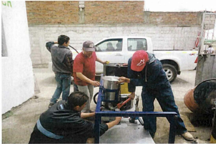
AJUSTE DE LA CENTRIFUGADORA Y ACOPLAS A LA ESTRUCTURA.
