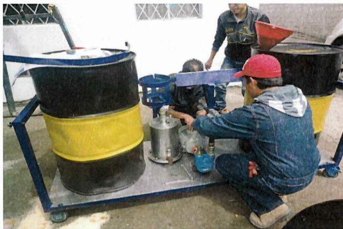
UNIÓN DE MANGUERAS Y ACOPLAS AL TANQUE Y MOTOR-BOMBA.
