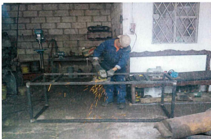
RETIRO DE LAS REBABAS DE LA SUELDA POR MEDIO DE LA AMOLADORA.
