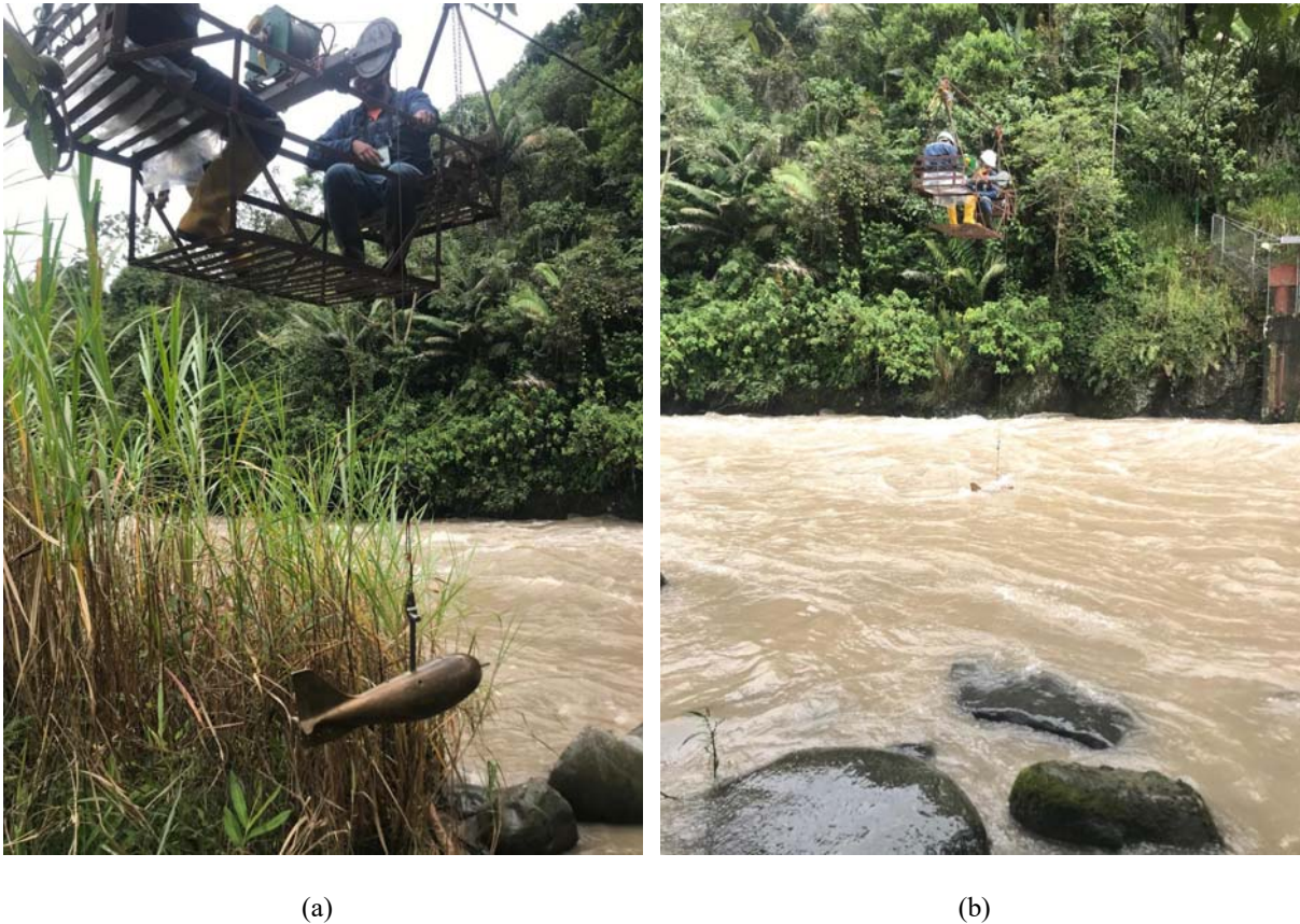
Figura 21: La figura (a) se puede visualizar el montaje del muestreador en la tarabita de la estación ESPERIE, en la figura (b) se puede ver la forma de recolección de muestras en el río Pilatón.
