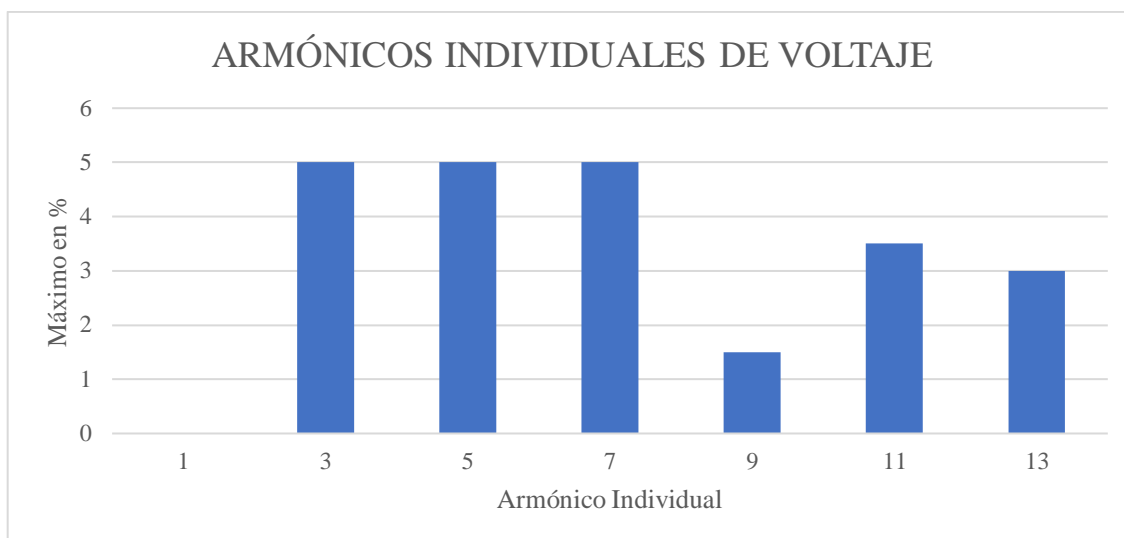
Figura 16. Nivel de distorsión armónica individual del transformador de 500 kVA.
