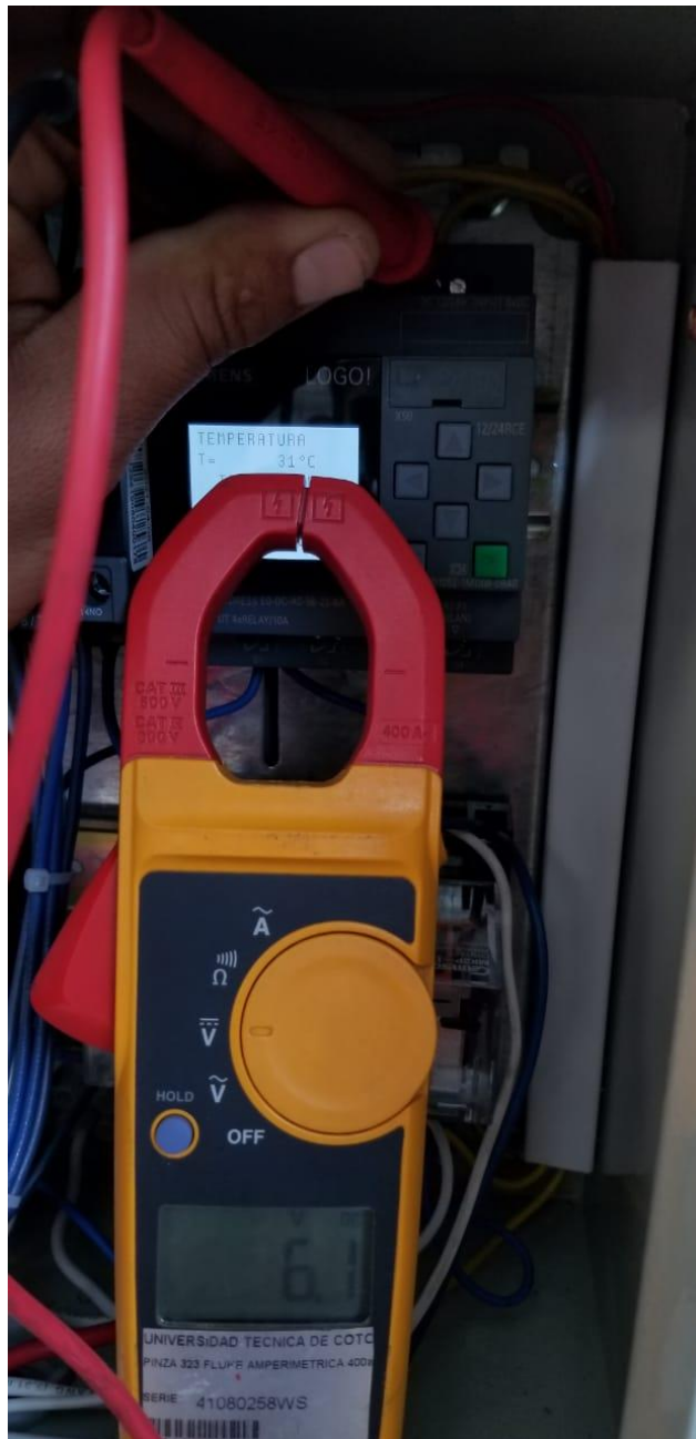
Figura W.2: Medición de la señal de voltaje del sensor de temperatura a 31°C.
