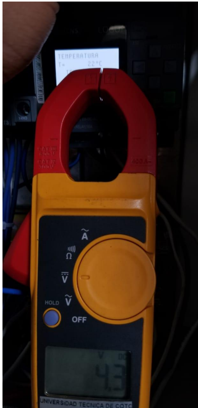
Figura W.3: Medición de la señal de voltaje del sensor de temperatura a 22°C.
