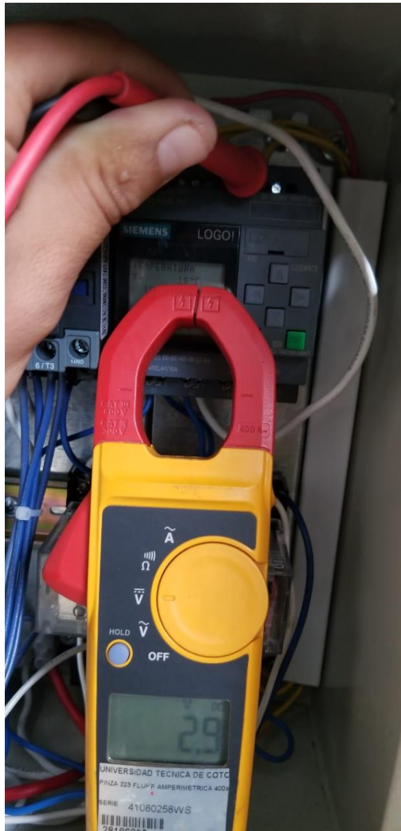
Figura W.1: Medición de la señal de voltaje del sensor de temperatura a 15°C.
