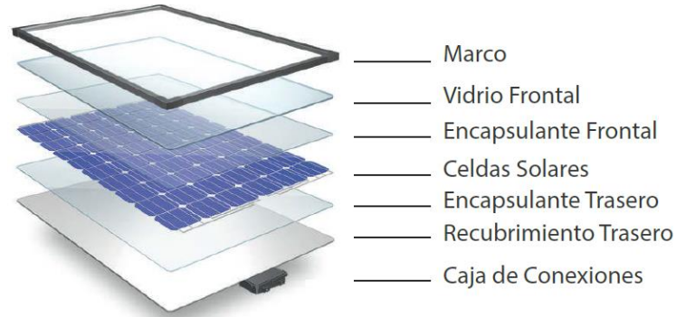
Figura 12. Partes de un panel fotovoltaicos [21].
