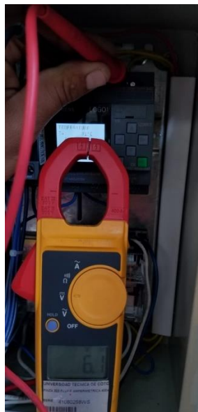
Figura 55. Medición de la señal de voltaje del sensor de temperatura a 31°C.
