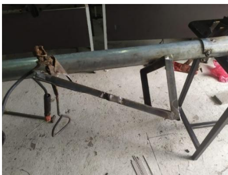
Figura 4.4 Estructura para el gabinete
