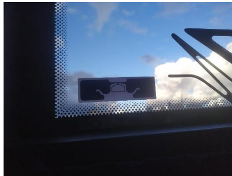
Figura 4.3. Colocación de la etiqueta RFID
