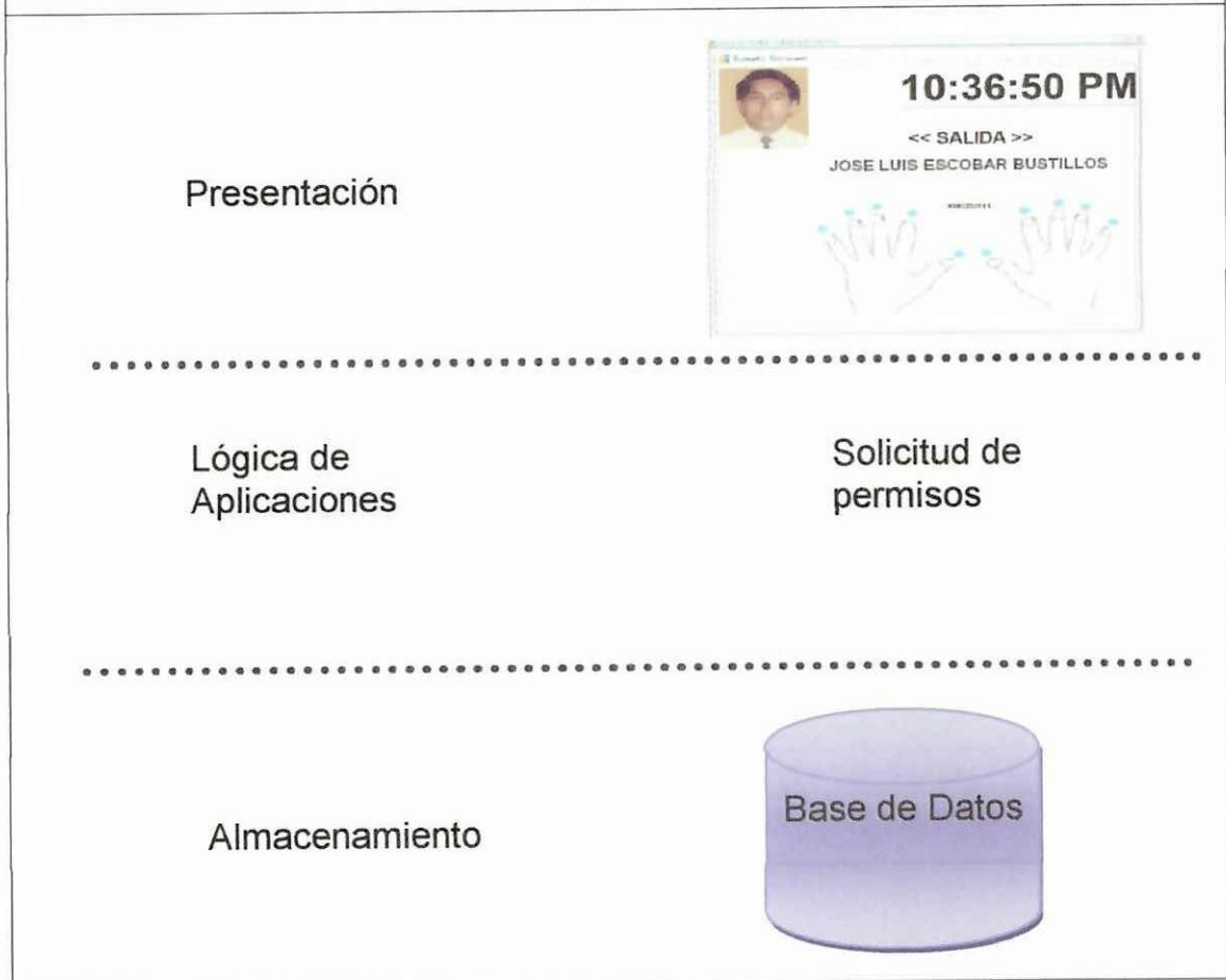
FIGURA N° 50 VISTA CLÁSICA DE UNA ARQUITECTURA DE TRES CAPAS
