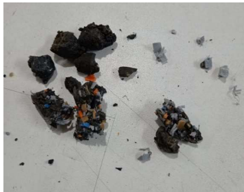
Figura 5.52. Material extruido con poca temperatura
