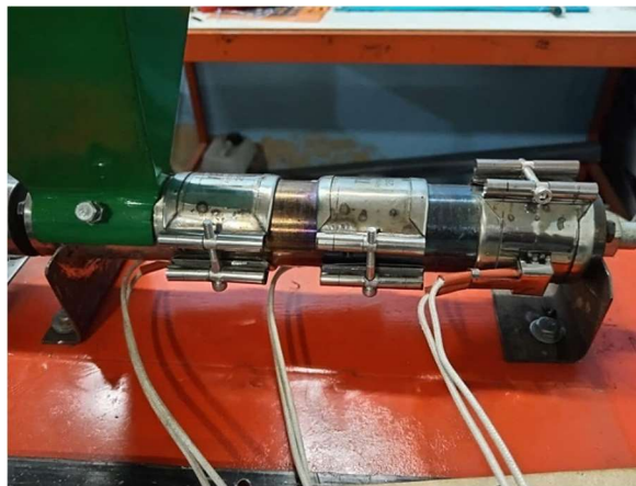
Figura 4.43. Instalación bridas resistivas en el cilindro de extrusión
