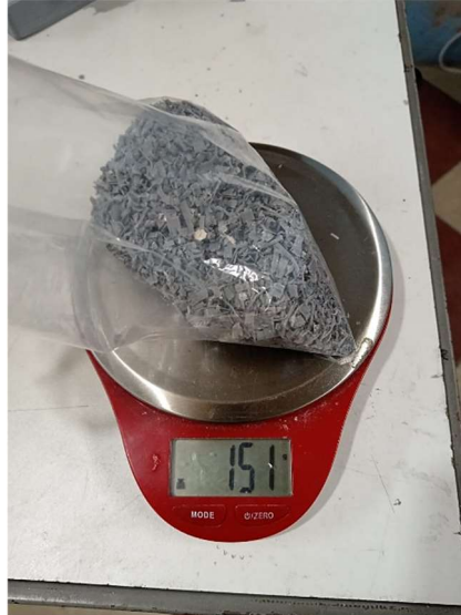
Figura 5.48. Desechos de impresión 3D trituradas y pesadas
