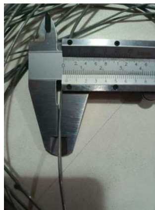
Figura 5.54. Verificación del diámetro de filamento del material extruido
