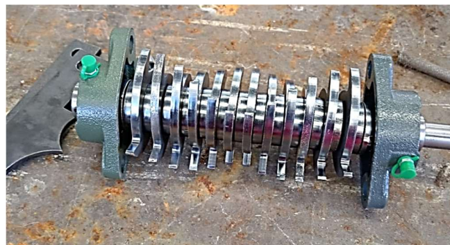
Figura 4.36. Colocación de las cuchillas y separadores
