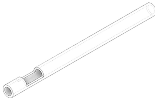
Figura 4.16. Cilindro acero AISI 316
