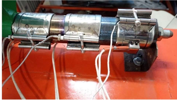
Figura 4.44. Instalación de las termocuplas en el sistema de calefacción
