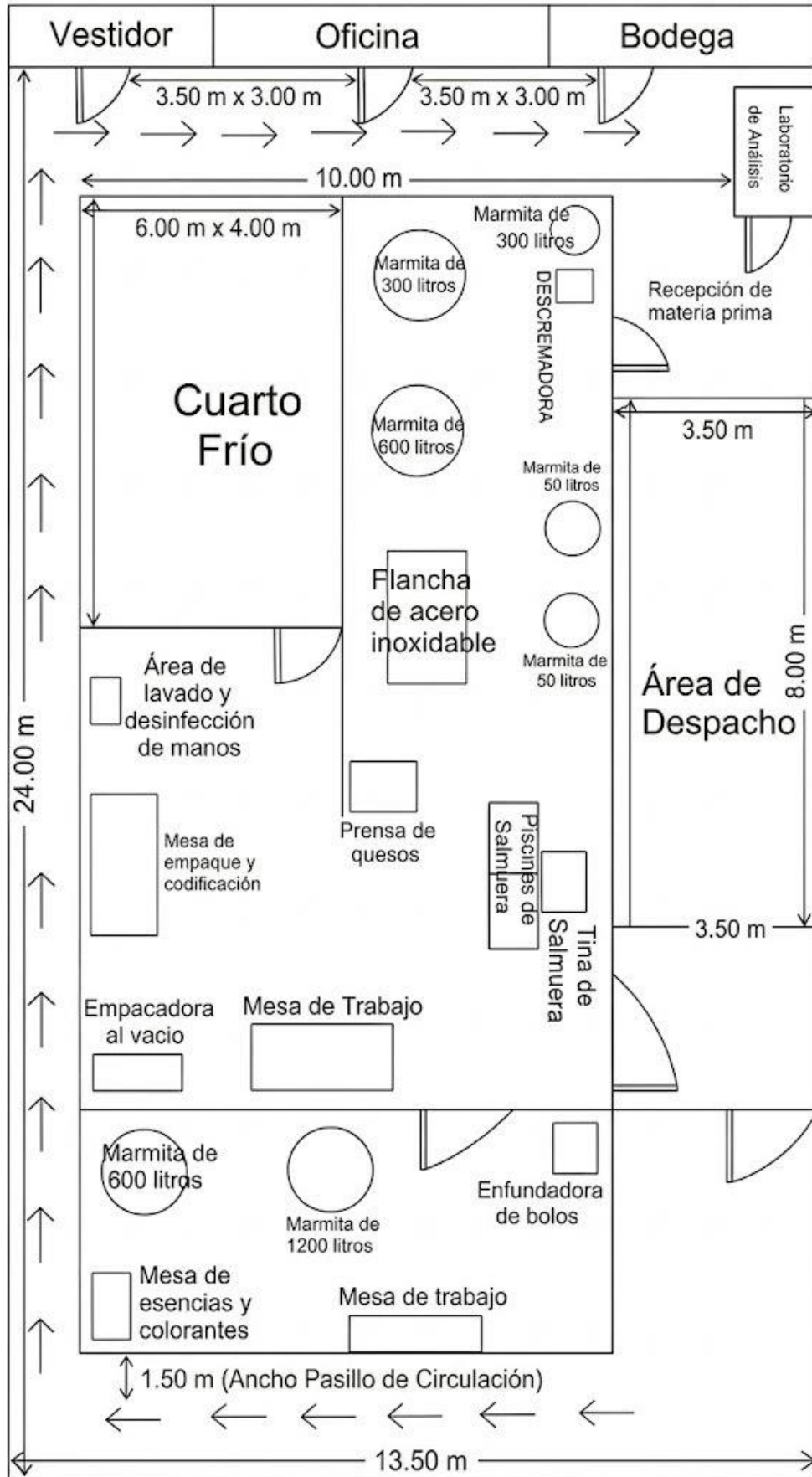
Figura 6. Layout del área de producción de la microempresa Productos Lácteos “FINO”
