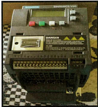
Figura N° 3. 2. Variador de frecuencia.
