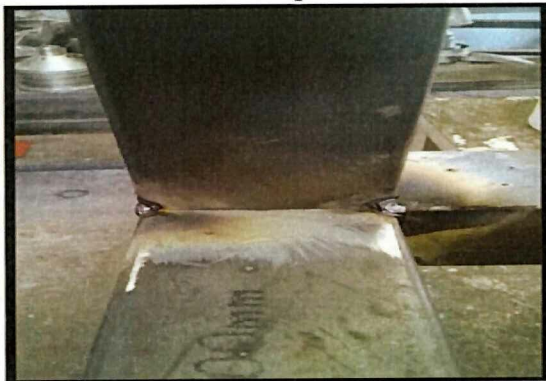
Figura N° 3. 12. Soldado de la parte inferior de la estructura.
