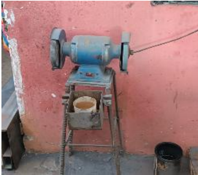
Figura 7. Esmeril para acabados de piezas metálicas.
