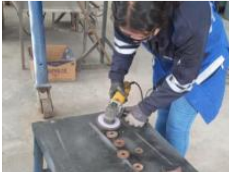
Figura 17. Desbaste de imperfecciones a las piezas metálicas con moladora
