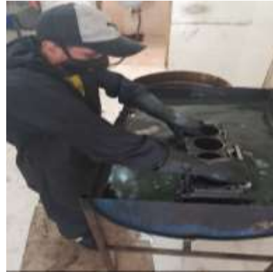
Figura 44. Equipo de protección personal y lavado de Bloque de motor
