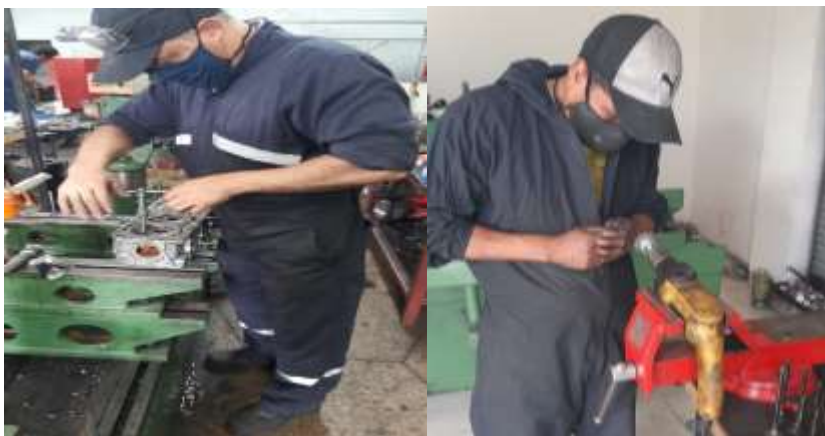
Figura 28. Proceso de rectificado de Cabezote
