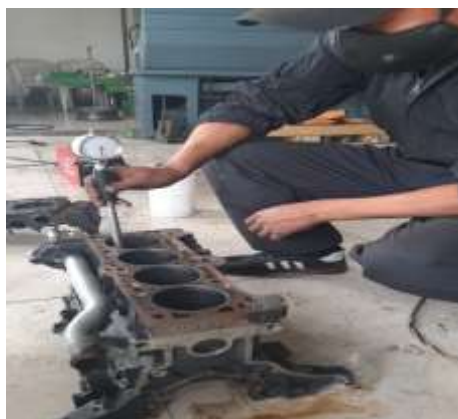
Figura 47. Control de medidas con instrumento (Reloj palpador)
