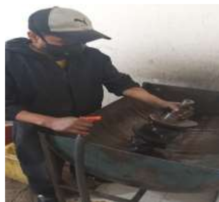
Figura 35. Equipo de protección personal y Lavado de Cigüeñal
