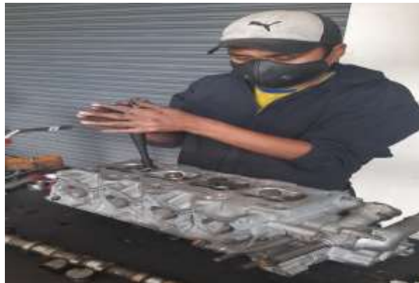
Figura 30. Verificación de asientos de válvulas herramienta
