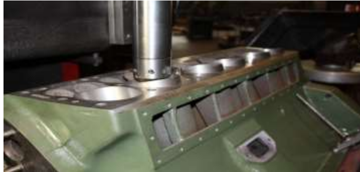
Figura 46. Rectificado con eje giratorio
