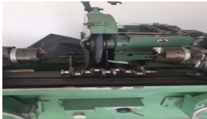
Figura 36. Colocación del cigüeñal en máquina de rectificar
