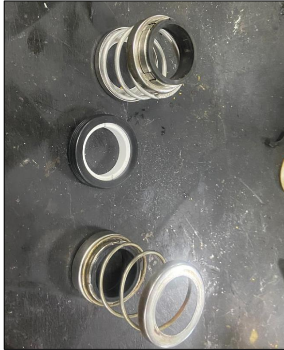
ANEXO G3: CAMBIO DE SELLO MECÁNICO.
