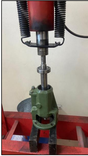
ANEXO F7: DESMONTAJE DE RODAMIENTOS.
