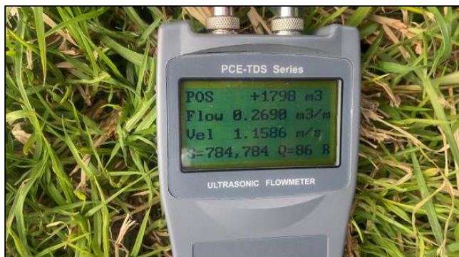
ANEXO II: MEDICIÓN DE CAUDAL.
