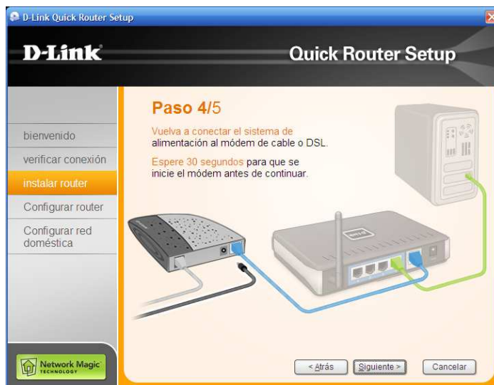
GRAFICO 3.5: ASISTENTE DE CONFIGURACION DEL ROUTER WIRELESS D-LINK DIR -300 FUENTE: EL INVESTIGADOR
