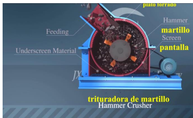
Figura 3.8. Trituradora de martillos [14].
