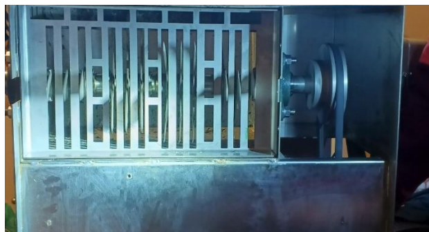
Figura 5.20. Nueva malla para trituración.
