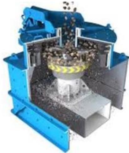
Figura 3.6. Vista interna de la trituradora de eje vertical [12].
