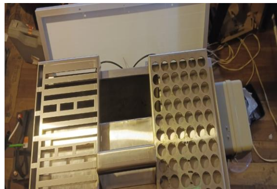
Figura 6. Tipos de zaranda o mallas para la trituración.
