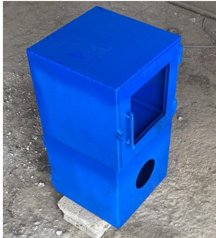
Figura 22. Estructura metálica del horno.
