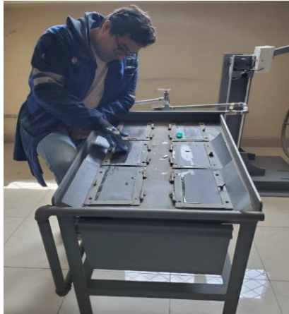
Figura 4.14. Desbaste de las muestras.
