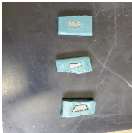
Figura 4.19. Muestras después del ataque químico.
