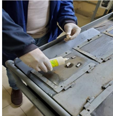
Figura 4.18. Ataque químico con nital.
