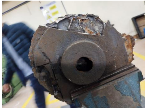
Figura 5.16. Grietas de solidificación.
