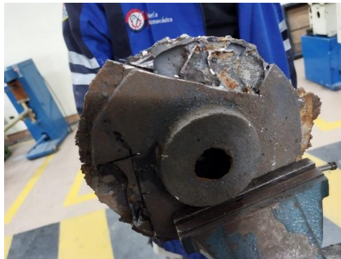
Figura 5.17. Proyección de metal irregulares en los bordes.
