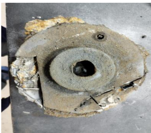
Figura 4.11. Corte del impulsor defectuoso.
