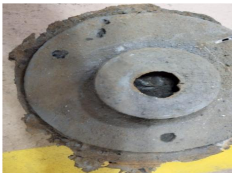
Figura 5.15. Rechupes e inclusiones en el impulsor.
