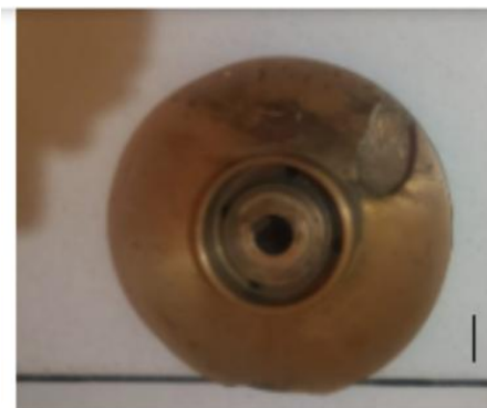
Figura 5.2. Impulsor de bronce-aluminio dañado.
