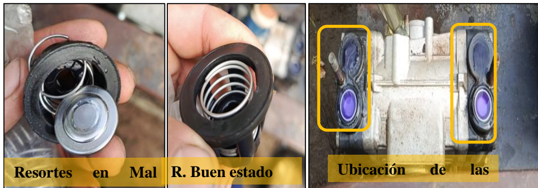
Figura Ñ. 4 Resorte de la válvula de succión: MALO, BUENO, UBICACIÓN DE LAS VÁLVULAS
