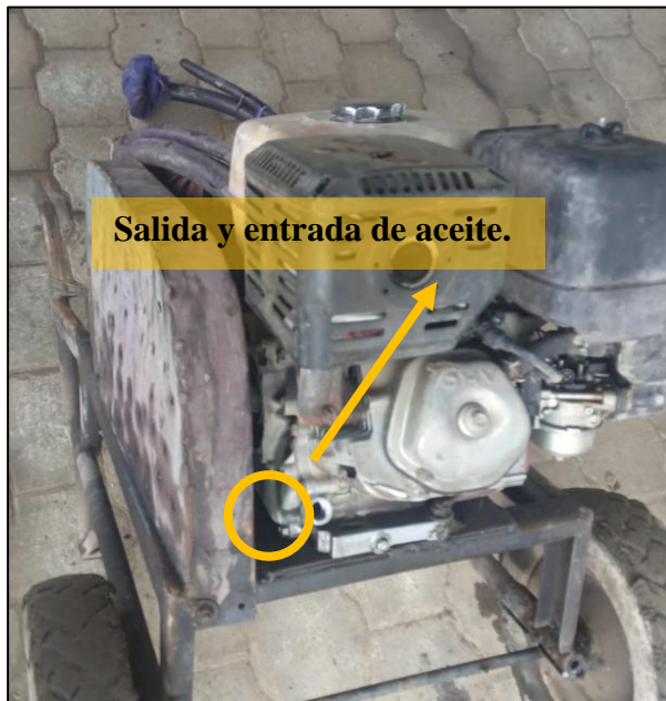
Figura Ñ. 14 Salida y entrada de aceite.
