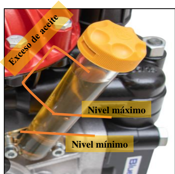
Figura Ñ. 1 Nivel máximo y mínimo de aceite
