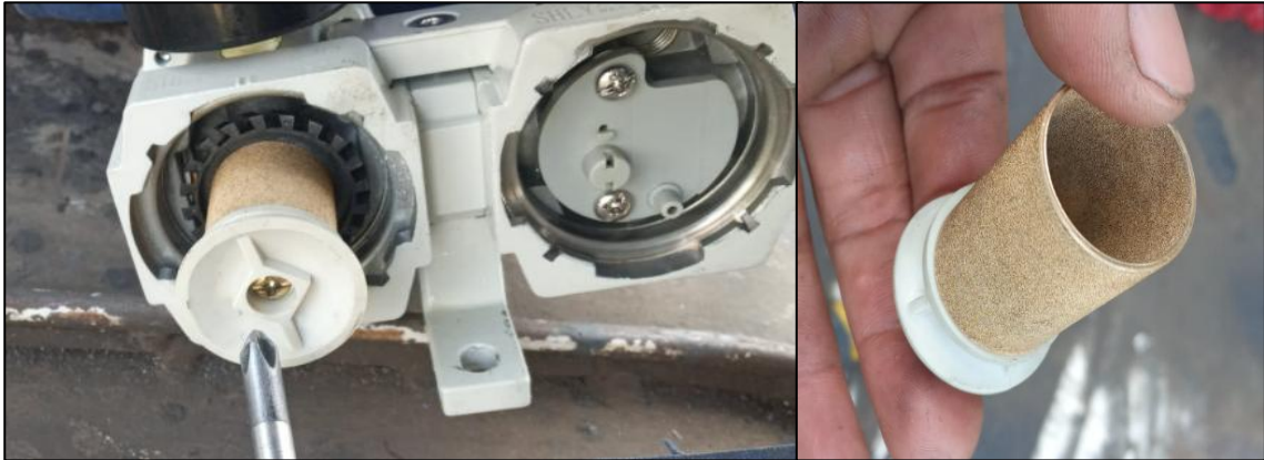
Figura P. 9 Desmontaje del filtro de aire
