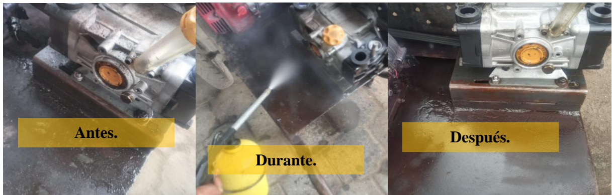
Figura Ñ. 17 Lavado de residuos de aceite
