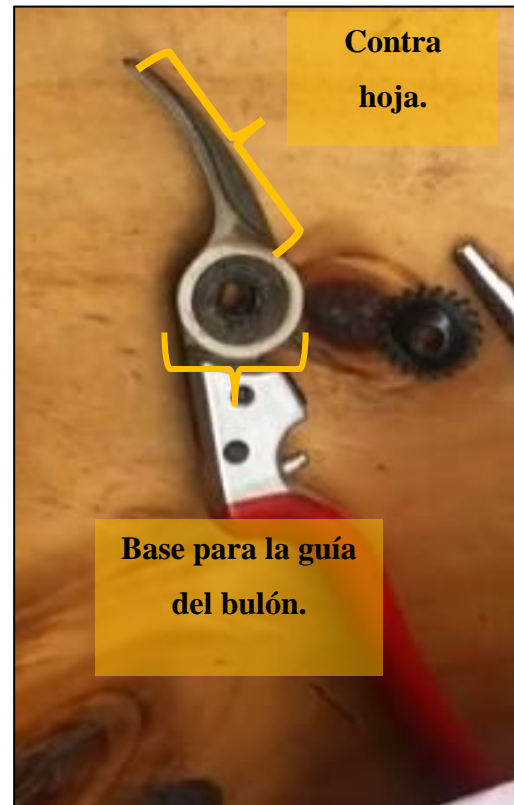
Figura Q. 7 Base de la guía para el bulón, Contra hoja.
