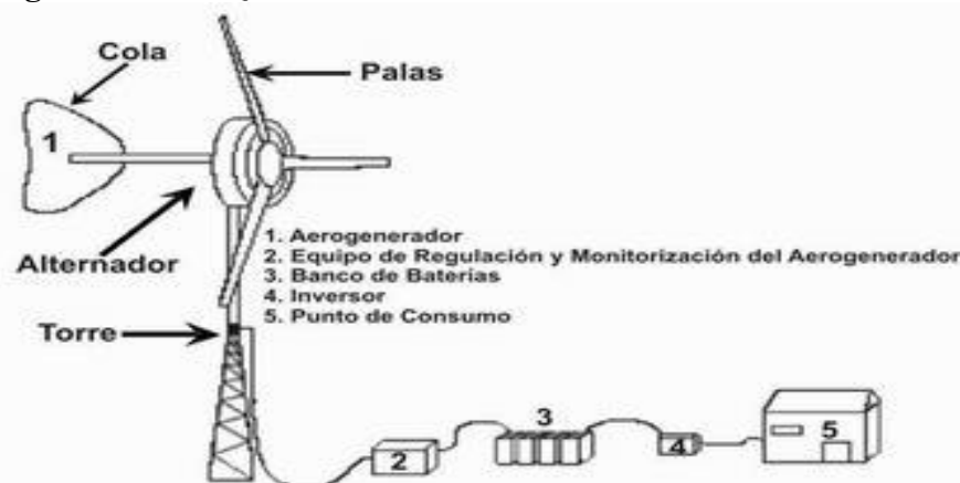
Figura 1.39 PEQUEÑOS AEROGENERADORES Y SUS PARTES.
