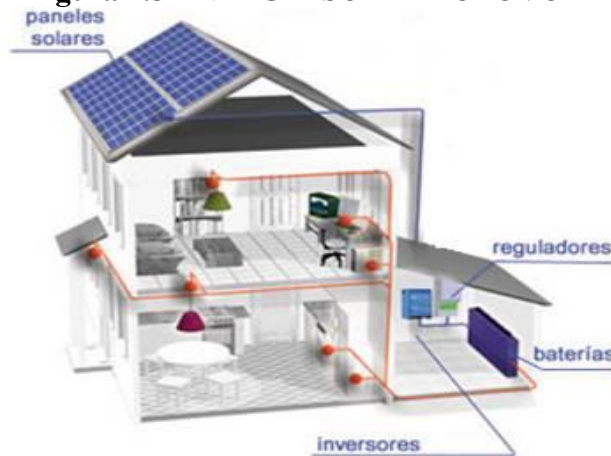
Figura 1.5 ENERGÍA SOLAR FOTOVOLTAICA.
