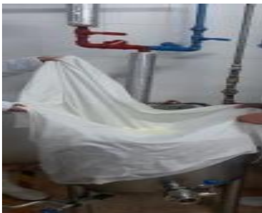
Figura 3. Filtración de jugo
