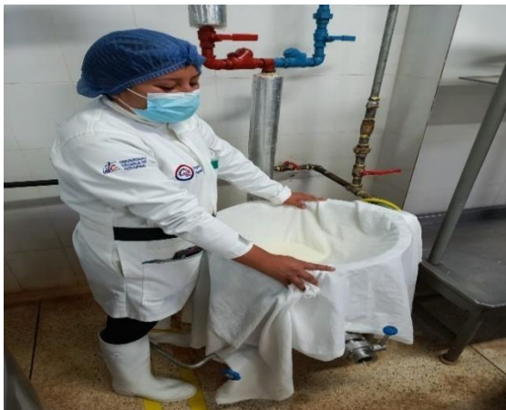
Figura 1. Filtración de la leche
