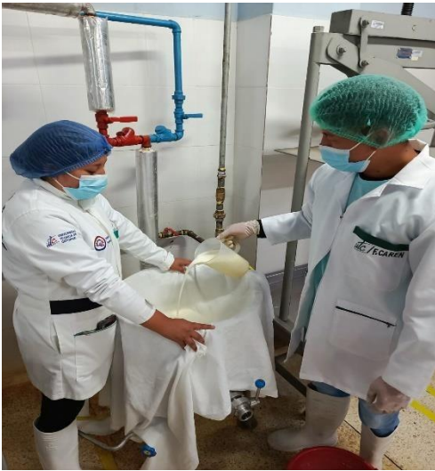
Figura 1. Filtración de la leche
