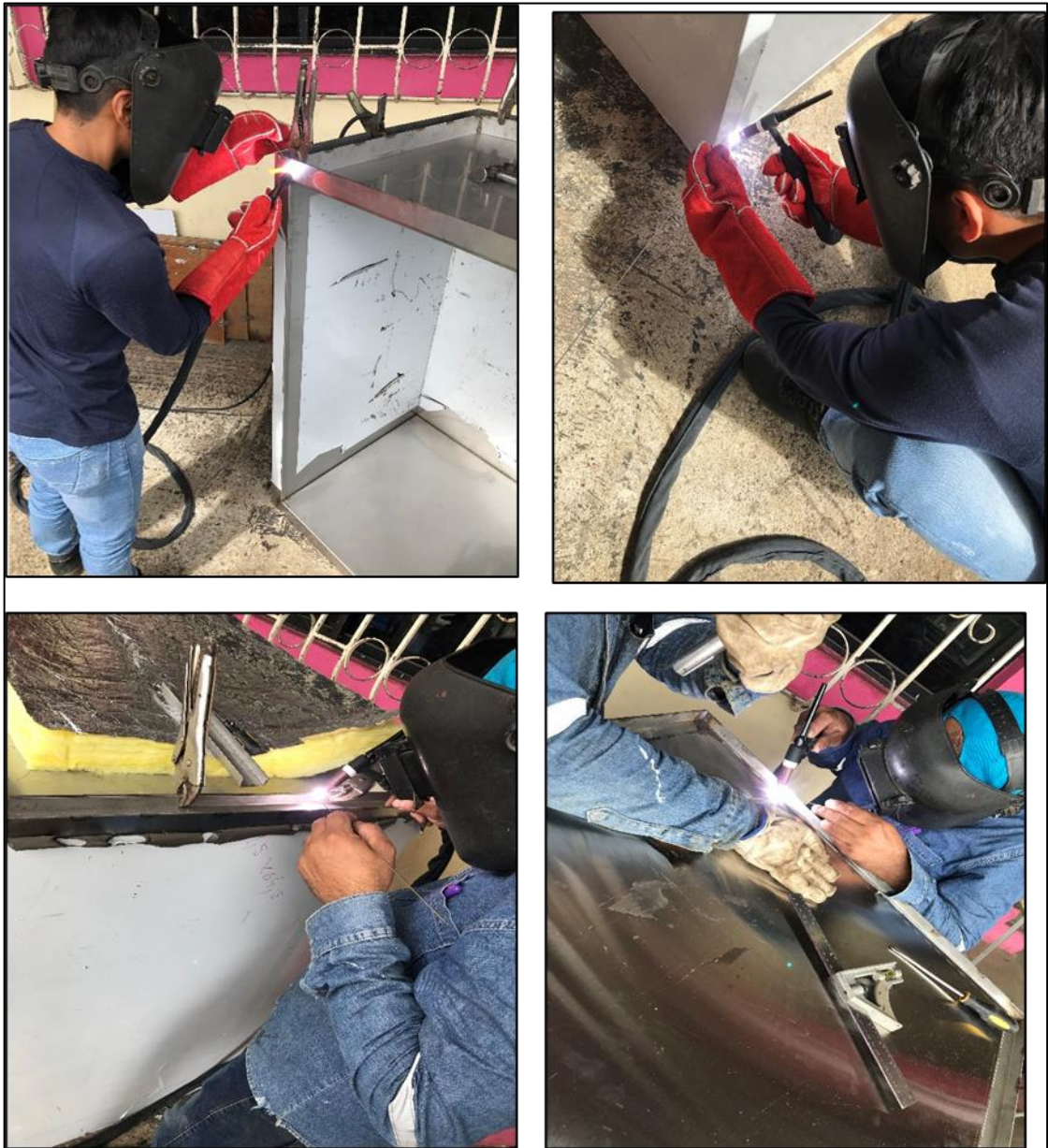
Figura 35. Soldadura de la estructura de la Maquina deshidratadora.
