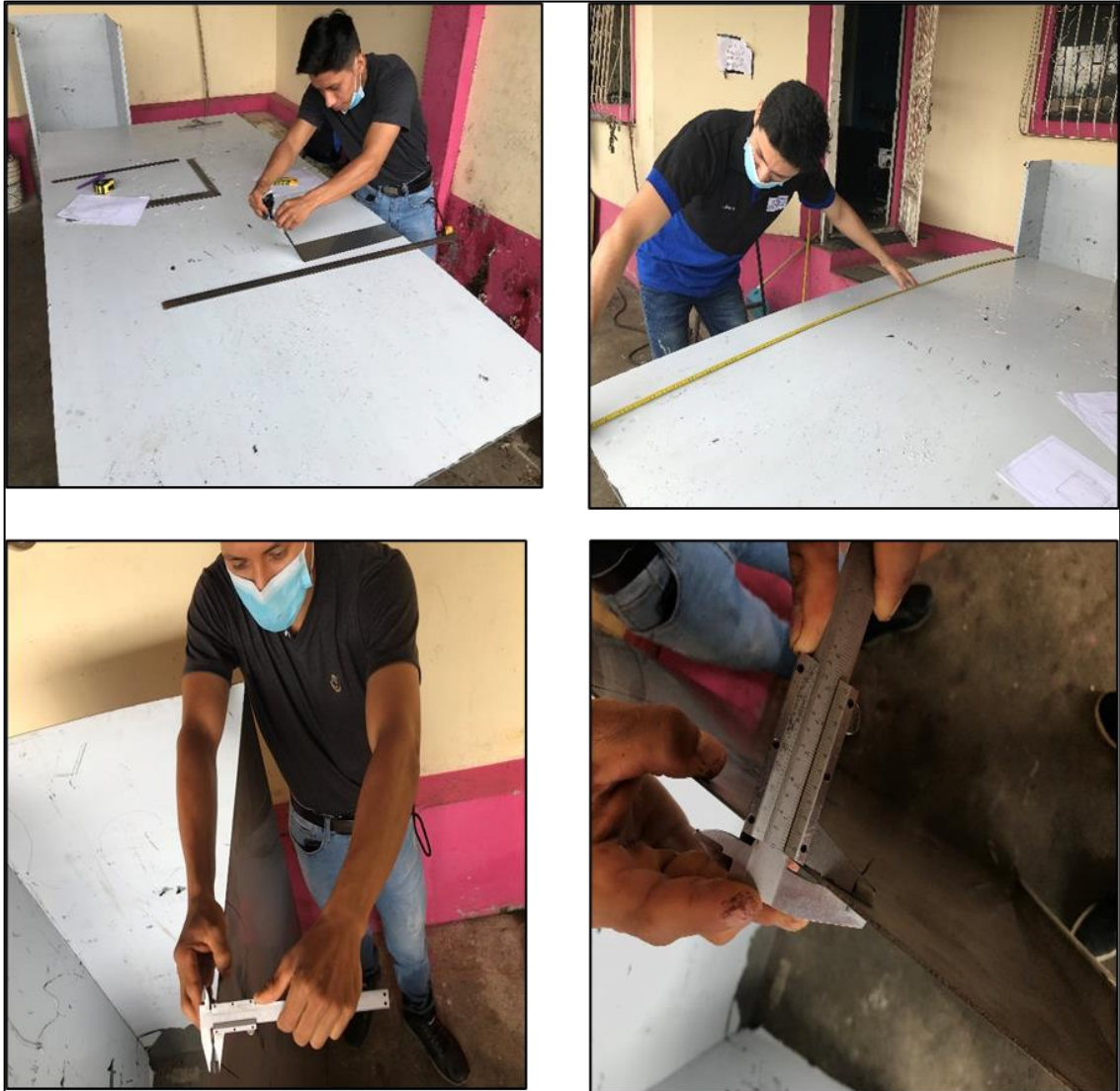
Figura 33. Medición y Corte del Material para la máquina.
