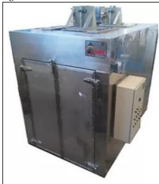
Figura 3. Deshidratador de combustión
