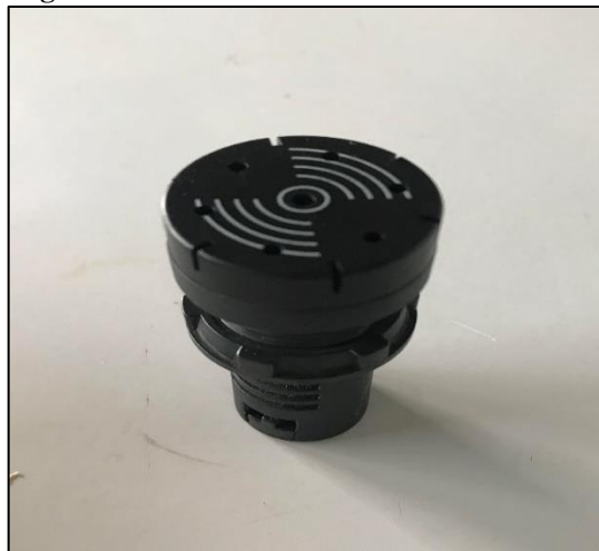
Figura 22. Alarma de fin de ciclo.
