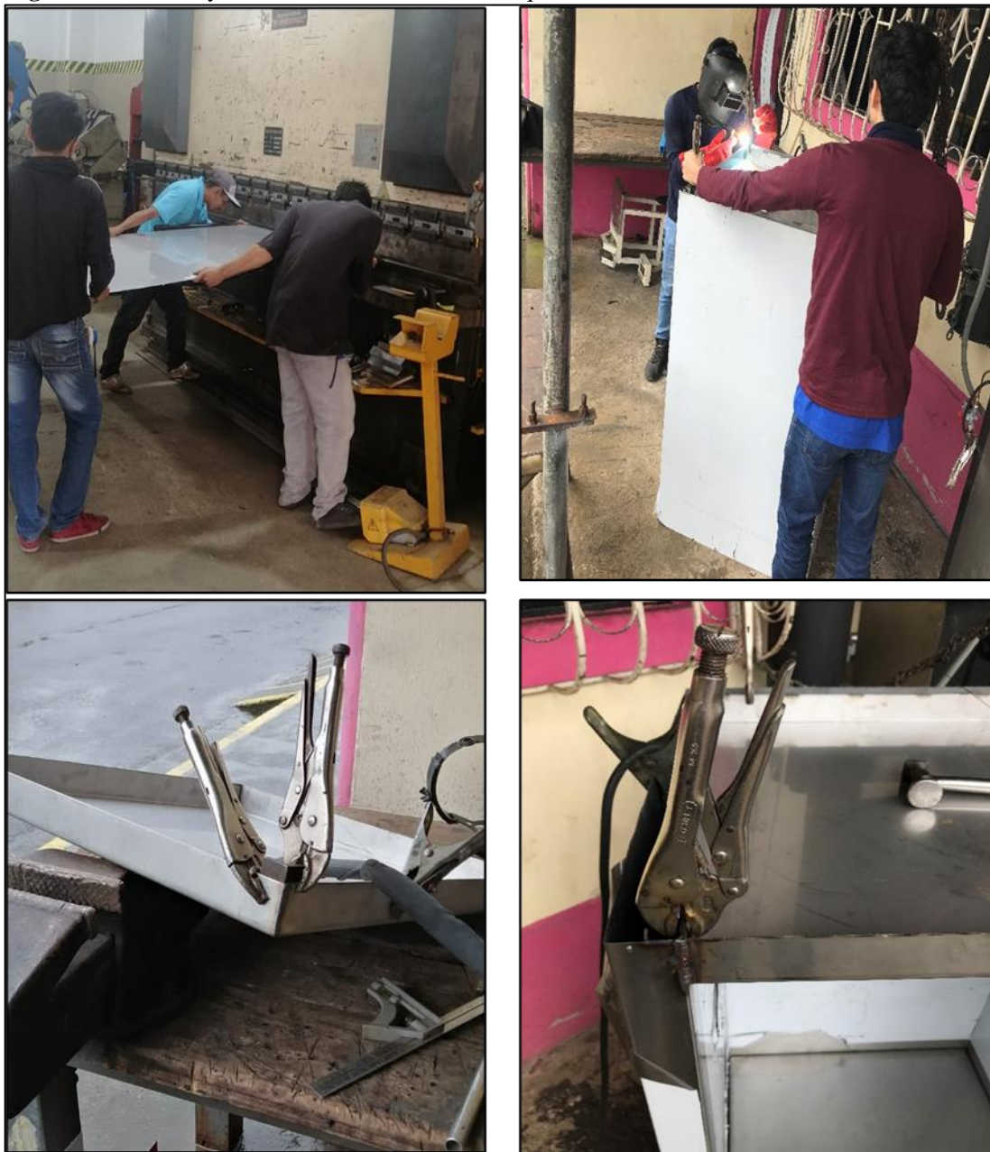
Figura 34. Doblado y unión de la estructura de la máquina.
