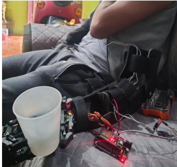
Figura 6.29. Simulación de agarre de la prótesis
